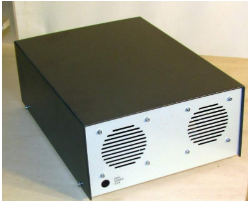
Leadshine M542 / 3 Achs 27V. 6,5A. 150W. (Vorgefertigte Baugruppe)
